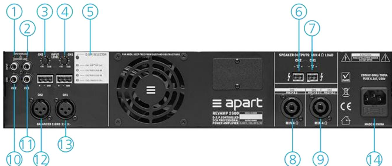
1. Индикатор перегрузки 2 канала: если горит этот индикатор, это означает, что аудио сигнал подаваемый на вход слишком сильный. Немедленно уменьшите уровень входного сигнала, чтобы избежать аварийного отключения усилителя.
