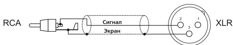
Рис. 2. Подключение несимметричного сигнала к разъему XLR одножильным экранированным кабелем.
