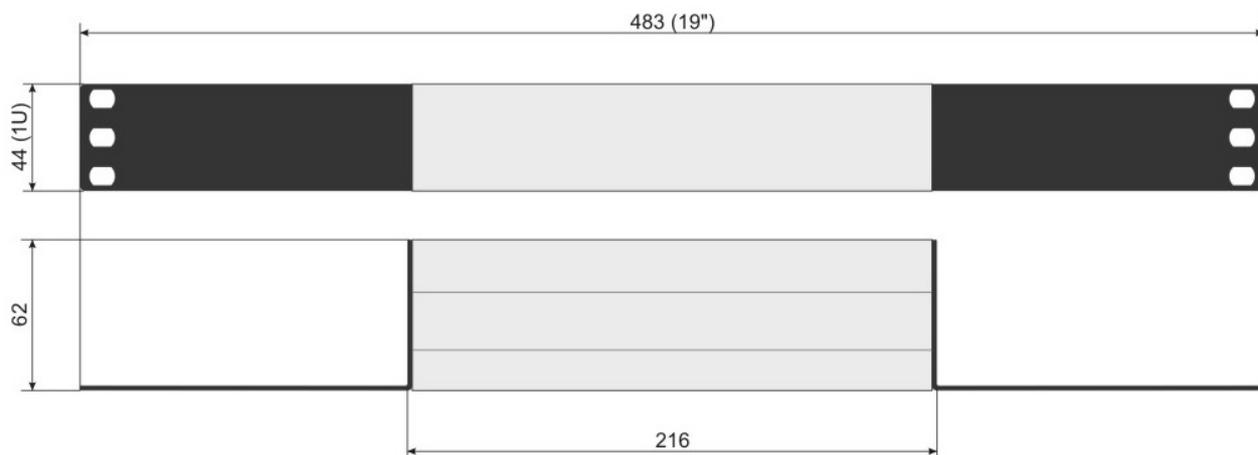
Исполнение для установки в приборную стойку, шириной 19" (483 мм) –
