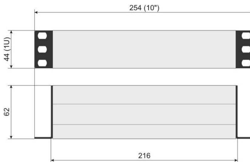
Исполнение для установки в приборную стойку, шириной 10" (254 мм) – **DS-13ASTM-1**
