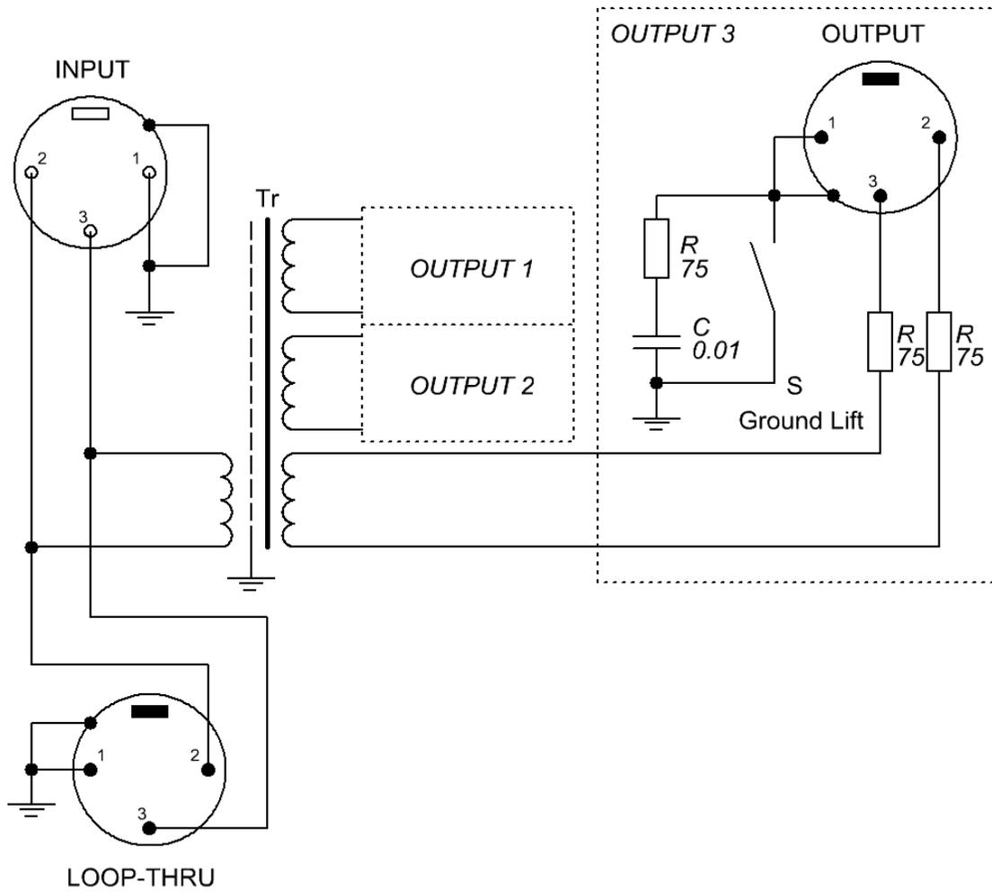
Рис. 1. Функциональная схема трансформаторного распределителя **DS-13ASTM**
