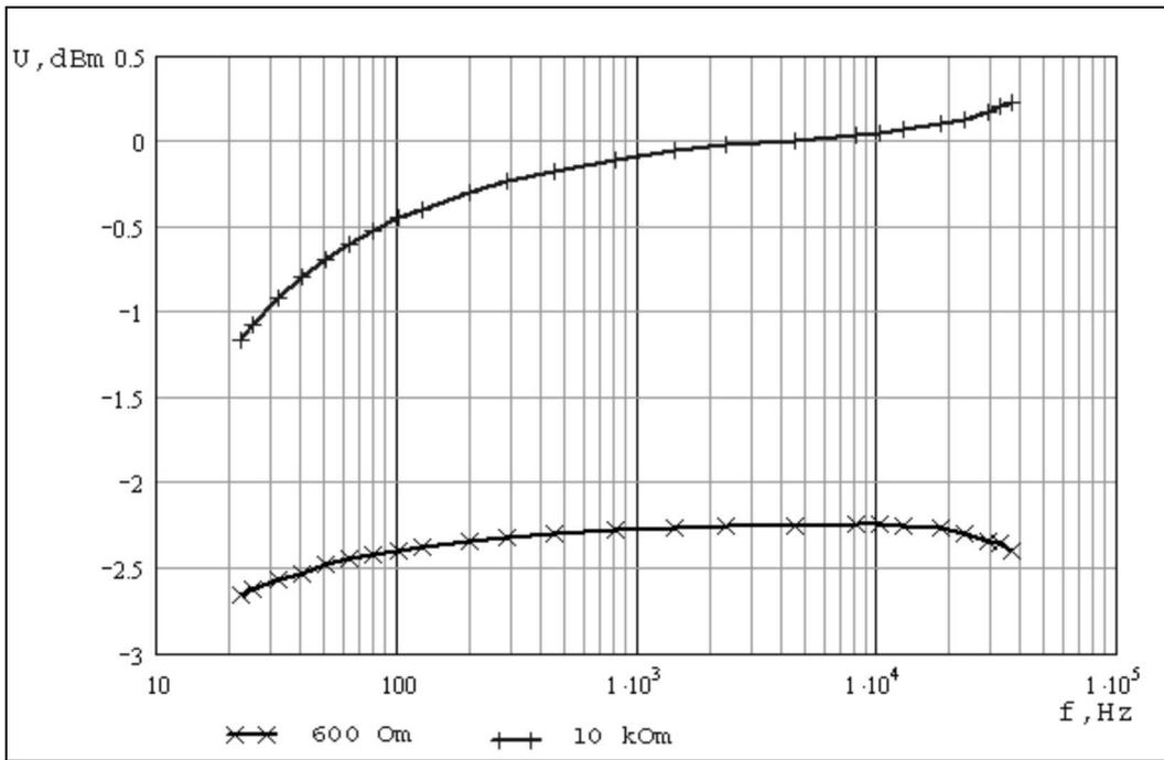
Рис. 2. Типовая зависимость суммарного коэффициента передачи от частоты входного сигнала и сопротивления нагрузки
