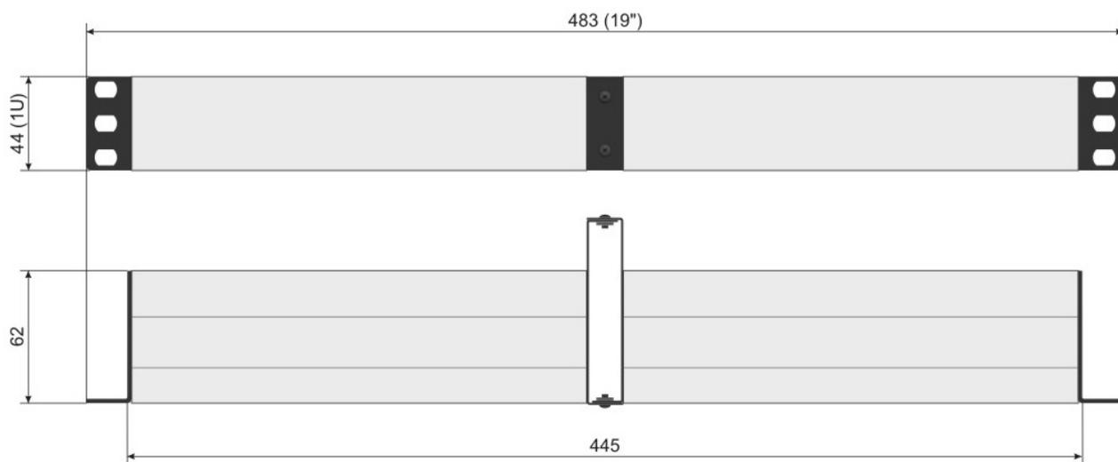
Парное исполнение для установки в приборную стойку, шириной 19" (483 мм) –
