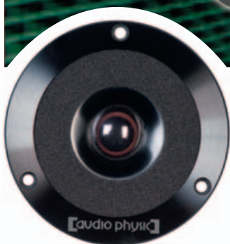
Den Hochtöner der Midex bezeichnet Audio Physic als Hyper-Holographic-Cone der dritten Generation. Ungewöhnlich ist die namensgebende Konusmembran, die im Hochton selten zu finden ist. Um das Resonanzverhalten zu optimieren, wird die Aluminium-Membran durch einen Gummiring vorgespannt.
