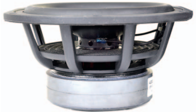
Der Tieftöner ist auf Leistung getrimmt. Die großzügige Sicke erlaubt hohe Auslenkungen, der Magnet sorgt für einen kräftigen Antrieb. Die Lüftungslöcher im Schwing-spulenträger dienen zur besseren Wärmeabfuhr.
