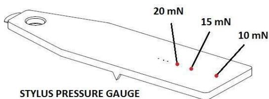
Чтобы отрегулировать прижимную силу, аккуратно двигайте противовес (11) вдоль опорного стержня, пока прижимная сила иглы не станет достаточной, чтобы поднять весы до ровного положения. Чтобы уменьшить прижимную силу, двигайте противовес (6) от звукоснимателя, а чтобы увеличить ее – к звукоснимателю. Наконец, зафиксируйте противовес (6) при помощи шестигранного ключа из комплекта поставки.
