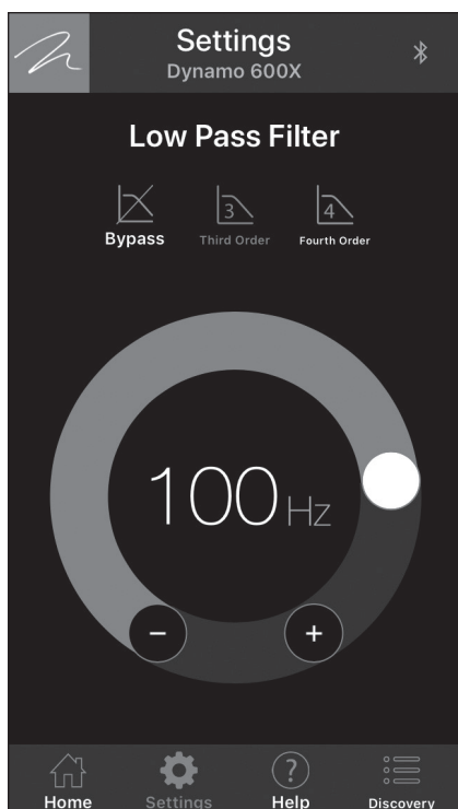
Figure 9. Écran Réglages : filtre de passe basse
