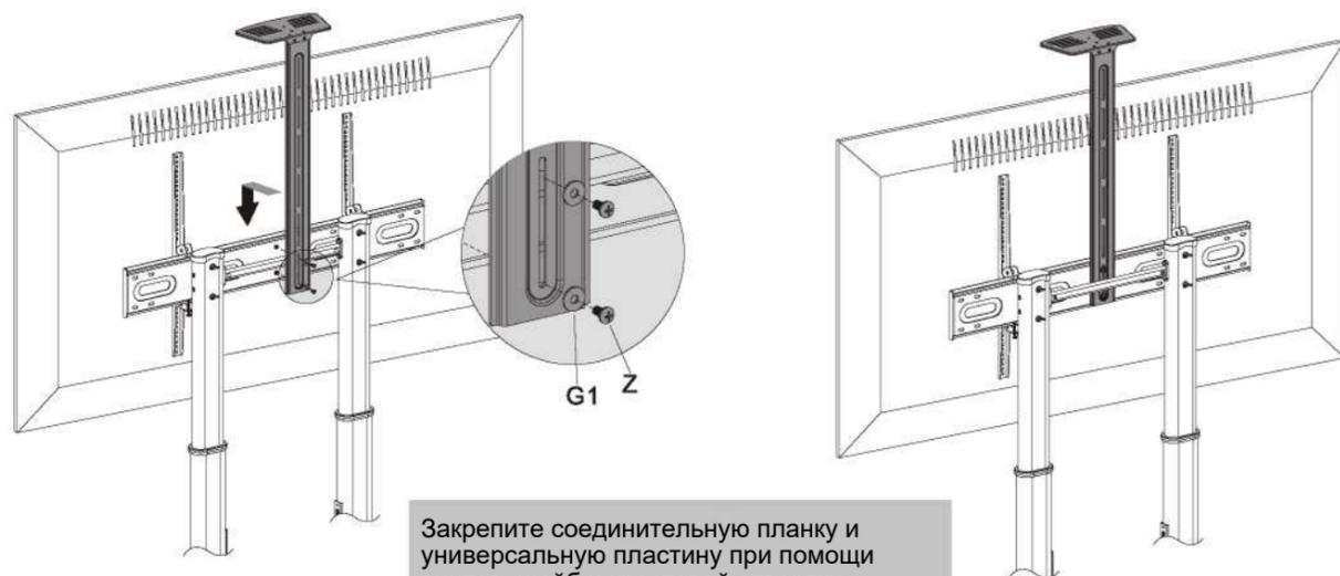
Закрепите соединительную планку и универсальную пластину при помощи винтов, шайб и крестовой отвертки.
