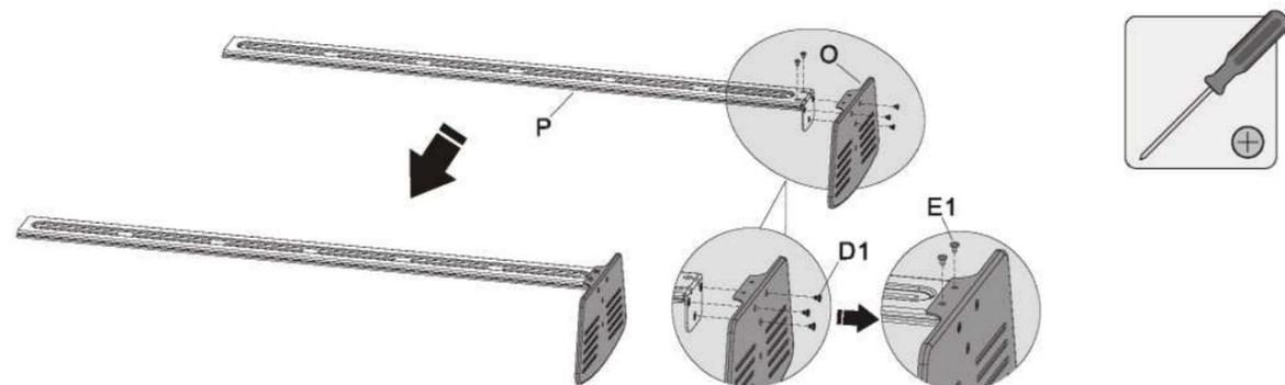
Закрепите полку для камеры на соединительной планке при помощи винтов и крестовой отвертки.
