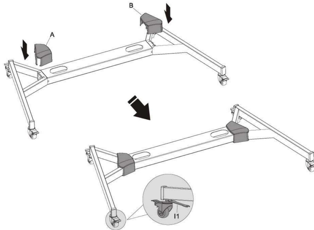
**ВНИМАНИЕ:** Во избежание случайного движения конструкции во время сборки заблокируйте ролики при помощи тормоза. Высоту каждого ролика можно настроить индивидуально. Ослабьте немного гайку для того, чтобы поднять или опустить основание.
