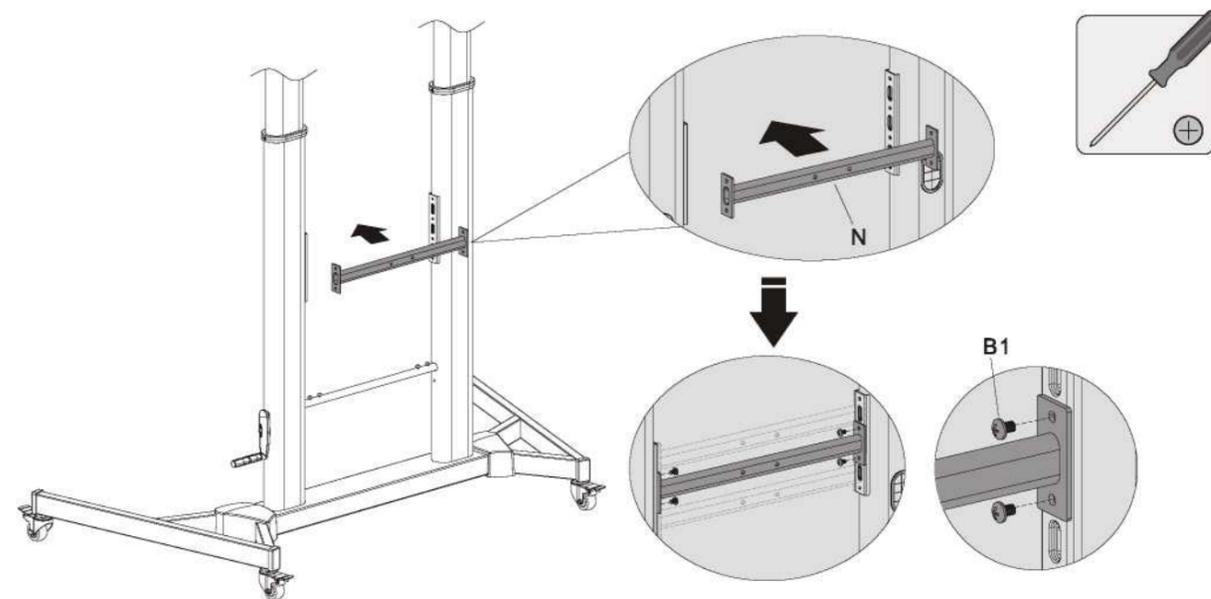
Закрепите опорную штангу между вертикальными опорами на необходимой высоте при помощи винтов.
