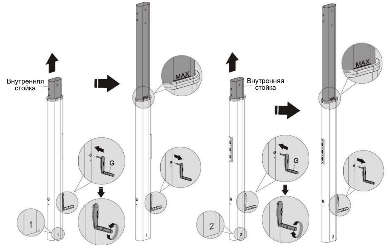
Прикрепите ручку к вертикальной опоре с номером «1». Прикрепите ручку к вертикальной опоре с номером «2». Для того, чтобы поднять внутреннюю стойку поверните ручку.
