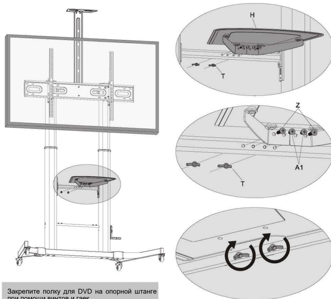
Закрепите полку для DVD на опорной штанге при помощи винтов и гаек.
