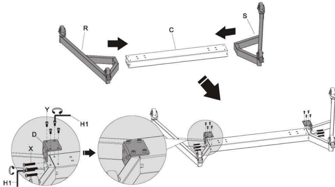
Установите правую опору в среднюю. Совместите отверстия обоих оснований. Закрепите основание при помощи уголка и винтов. Повторите то же самое с левой опорой.
