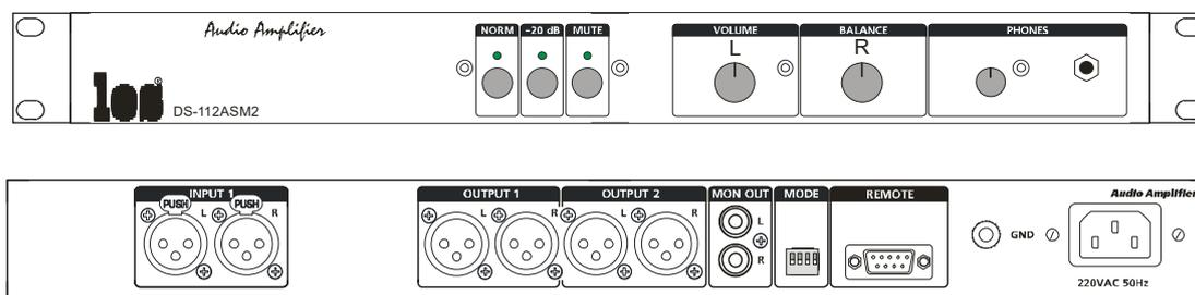
Конструктивно устройство выполнено в стандартном приборном корпусе высотой 1U (44 мм) и предназначено для установки в 19-дюймовую стойку.
